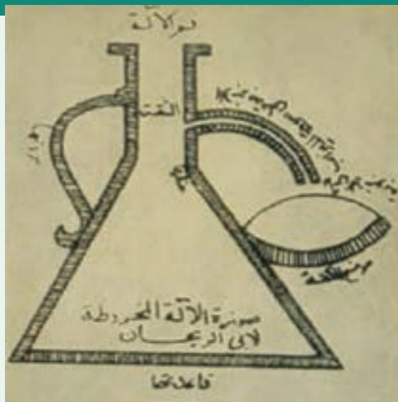
Abu Rayhon Beruniy «Mineralogiya». XI asr. Suvga tushirilgan namuna asosida siqib chiqarilgan suyuqlikning hajmini aniqlash moslamasi chizmasi.
